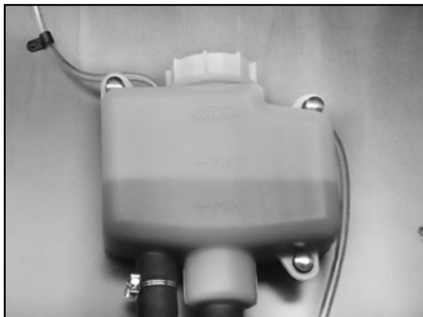
Serbatoio per il controllo e l'aggiunta del liquido
